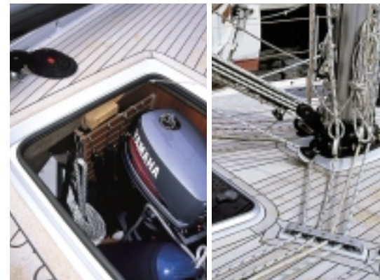
Ein vernünftiger Stauraum hinterm Ankerschapp. Alle Fallen und Strecker werden ins Cockpit umgelenkt.
