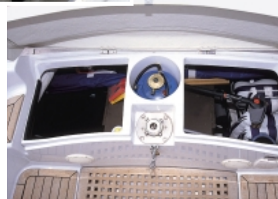
Die elektrische Ankerwinde gehört zur Serienausstattung, ebenso die optimale Kettenführung. Den Zugang zum geräumigen Stauraum achtern findet man unter dem gewölbten Sitz des Steuermanns. Dort sind auch der Beschlag für die Notpinne sowie der Gaskasten (leider nur mit Platz für eine 2,8-Kilo-Flasche).
